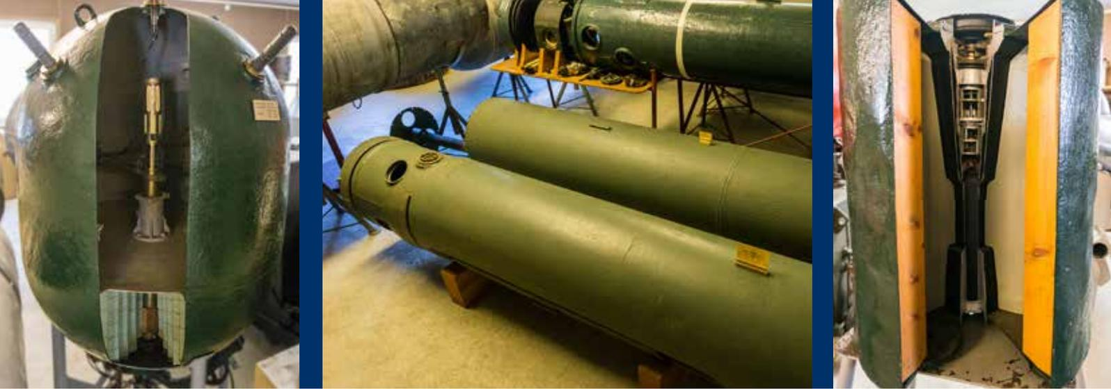
Generell gelten Stoffe, deren Schlagempfindlichkeit kleiner als 40 Nm ist, als empfindlich und ab einem Wert kleiner als 4 Nm als sehr empfindlich. Die ersten Ergebnisse der Schlagempfindlichkeitsuntersuchungen zeigen, dass fast alle Proben aus marinen Kampfmitteln schlagempfindlich sind.
